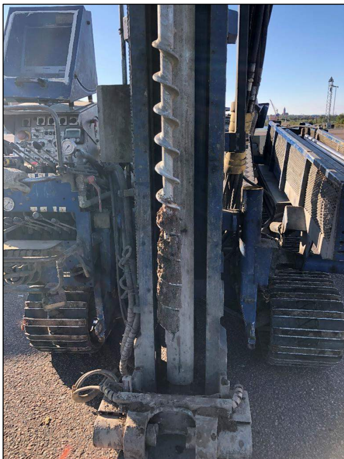
Figur 3. Foto (AFRY) av provpunkten 20AF06 (0-1,0) där övre lagret utgjordes av krossad sten (makadam).
